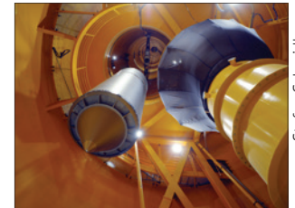
Blick ins Innere der Fallröhre mit einer typisch geformten Fallkapsel.
