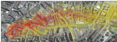
Schadstoffkonzentration (hohe Werte in rot) in der Altstadt von Hannover auf Fußgängerniveau. PALM Simulation eines fiktiven Störfalls am Steintorplatz.
